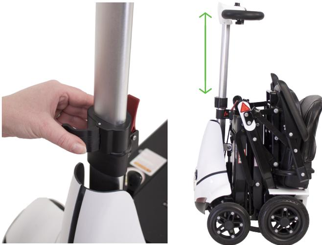
Um die Neigung der Lenksäule für ein komfortables Fahrgefühl richtig zu justieren, drücken Sie den Hebel nach vorn, stellen die gewünschte Neigung ein und lassen ihn wieder los.
