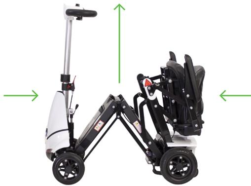
Als letztes Entriegeln Sie die Sicherung der Lenksäule und schieben Sie die Lenksäule wieder ganz herein. Danach verschließen Sie die Sicherung wieder.
