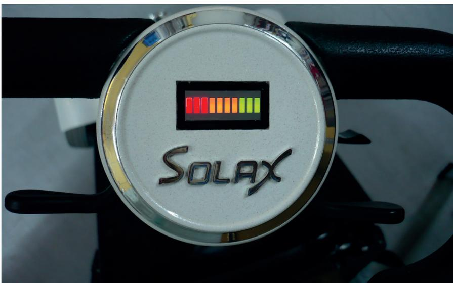
So ist Ihr Akku vollständig aufgeladen. Verringert sich die Akkukapazität, verschwinden erst die grünen Balken, dann die orangenen Balken, so dass nur noch die roten Balken sichtbar sind. Nun sollten Sie schnellstens den Akku wieder aufladen.
