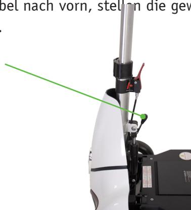
Um die Armlehnen bei Bedarf zu entfernen, lösen Sie die Handrändelschrauben, drehen den Schnellspanner heraus und ziehen die Armlehne zur Seite heraus. Bitte drehen Sie danach die Handrändelschrauben wieder fest.
