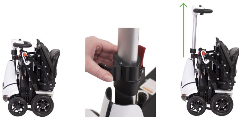
Entriegeln Sie den Klappmechanismus, indem Sie den roten Hebel an der Lenksäule gedrückt halten. Sie können den Mobie nun auseinander ziehen, die Fußstütze nach unten drücken und den Sitz in eine aufrechte Position bringen.
