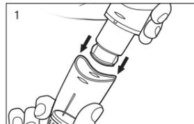
**Graphik 2:** Ziehen Sie sanft am Ventilsystem, um es zu entfernen. **Drehen Sie nicht** am Hauptteil oder Ventilsystem, da dadurch der unten angezeigte Zapfen beschädigt werden kann. Um es wieder zusammenzubauen, stellen Sie den Zapfen mit dem Einschub auf und verschieben Sie ihn.
