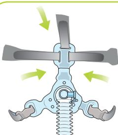
Assemblez le harnais sur le masque en fixant une à une les 3 branches supérieures dans les encoches. Puis connectez le tube sur le masque silicone.
