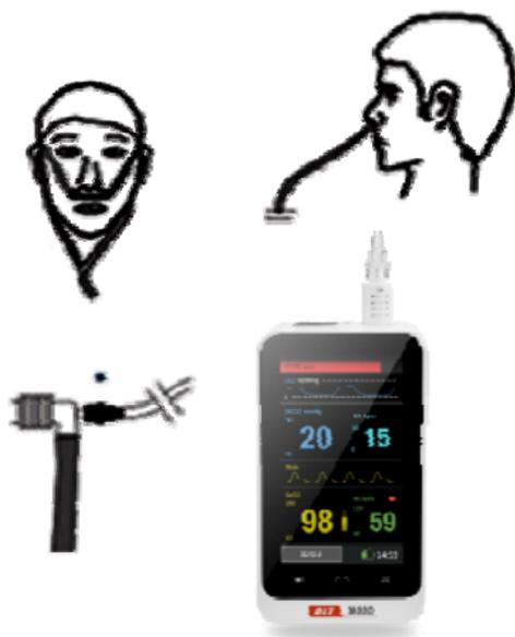
**Fig 5-1-2 Connexion de l'échantillonnage avec le robinet d'arrêt à 3 voies CO2 ou le nez du patient**
