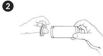
2. Nehmen Sie den Universaladapter ab, indem Sie den Daumen in die Öffnung stecken. Ziehen Sie mit Kraft das komplette Rückteil heraus.
