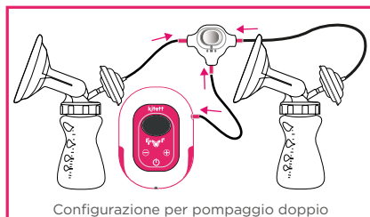
Configurazione per pompaggio doppio
