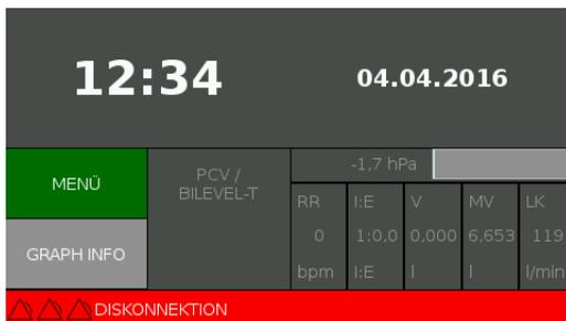
Wenn sich das Gerät im Standby-Zustand befindet (d.h. mindestens zwei Minuten nicht bedient wurde), erscheint eine Alarm-Liste, die das ganze Display ausfüllt, sowie ein akustisches Signal ertönt.
