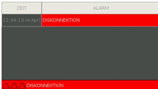
Nach dem Druck einer beliebigen Taste wechselt das Gerät in den aktiven Zustand. Dann werden die Alarme wieder in der Statuszeile angegeben.
