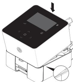
5. Schließen Sie das Netzkabel am Gerät an. Sichern Sie das Netzkabel mit Hilfe des Sicherungsbügels am Gerät. Das andere Ende des Netzkabels
