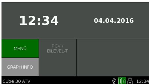
Der Standby-Bildschirm zeigt im oberen Bereich die Uhrzeit und das Datum. Wenn ein Atemluftbefeuchter angeschlossen ist, wird in diesem Bereich die eingestellte Heizleistung des Atemluftbefeuchters angezeigt. Das Einstellen der Heizstufe erfolgt dann über die Rechts-/Links-Tasten.
