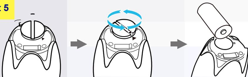
Entsorgen Sie ggf. Reste der Verneblerkammer. Füllen Sie die Kammer dann halb voll mit Wasser und schwenken Sie das Gerät danach vorsichtig. Schalten Sie nun den OxyHaler für 60 Sek. ein, um das Wasser zu vernebeln (warmes Wasser eignet sich am besten).
