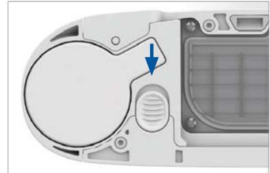
7. Während die Taste offen gehalten wird, die Säule (Metallröhre) herauschieben. Dazu die exponierte Aluminiumfläche mit einer Hand greifen.
