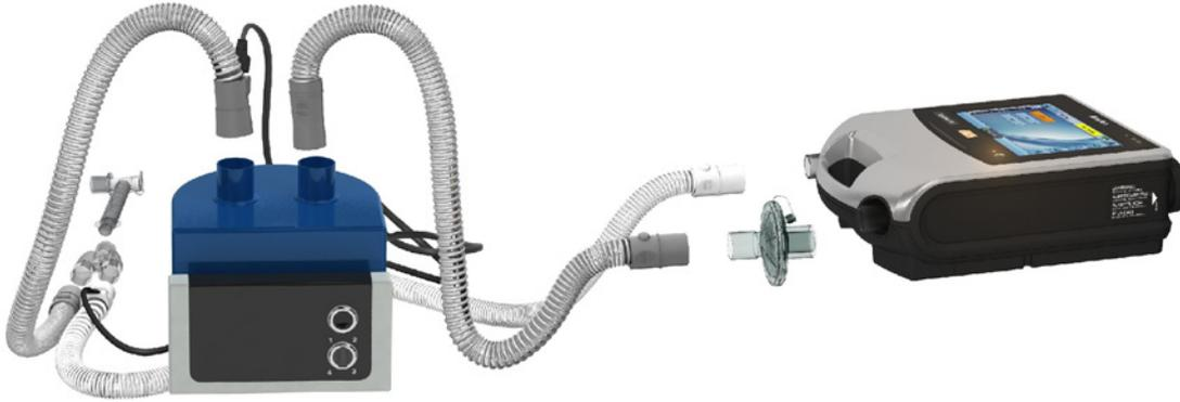
Lors de l'utilisation de l'humidification par élément chauffant dans un circuit double, de la condensation peut se former dans le capteur de débit expiratoire si l'air est refroidi sous le point de rosée. De la condensation peut également se former dans le circuit patient et se formera vraisemblablement dans des conditions d'humidité élevée et de basse température ambiante.
