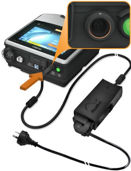
**Remarque :** Le câble d'alimentation est muni d'un raccord à verrouillage de type « pousser-tirer ». Pour le retirer, saisissez la douille du câble d'alimentation et sortez le raccord de l'appareil en tirant doucement. Ne tordez pas la douille externe et ne tirez pas sur le cordon.
