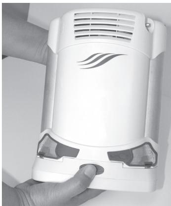
3. Inserte la fuente de alimentación de CA o CC en el receptáculo del puerto de alimentación ubicado en la parte delantera inferior derecha de la unidad.
