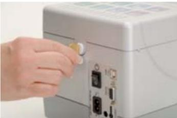
Drehen Sie den Filterkassettenverschluss in eine senkrechte Stellung.
